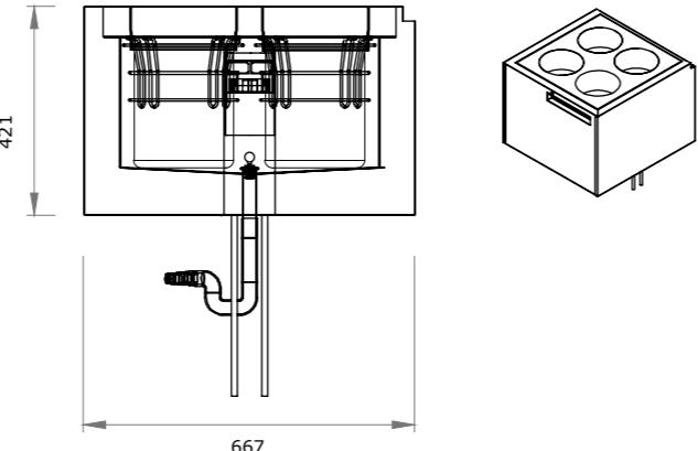
**BANCO POZZETTO VENTILATO CON RISERVA MOTORE ESTERNO**
